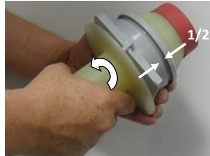
Retire el capuchón protector del Mango instalador y con suficiente fuerza perfore el politubular, logrando que éste se aloje en el espacio de ½ centímetro que quedó entre la tuerca y la válvula, como se describió en el punto anterior.
