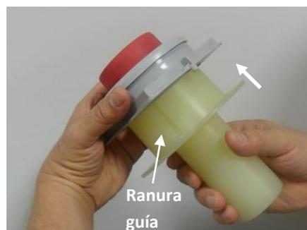
Sosteniendo el marco gire el mango instalador en el sentido contrario de las manecillas del reloj, de tal forma que la Tuerca se desenrosque de la válvula hasta alcanzar una distancia entre las partes, máxima de ½ centímetro.
