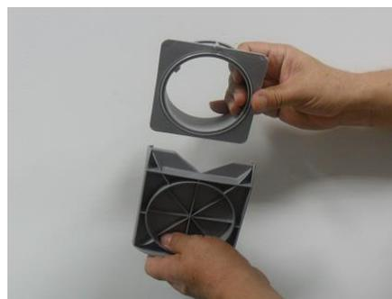
Introduzca el mango instalador por el mismo lado donde acaba de retirar la ventana, cuidando hacer coincidir la ranura guía del mango con la guía interna de la Tuerca.
